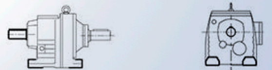
Serie ERS (entrada y salida por eje sin motor) ERS series (shaft input and output without motor)
